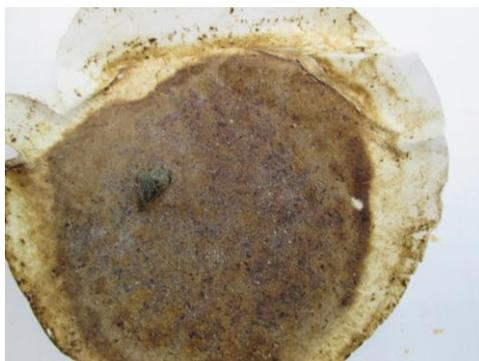
Рисунок 3. Фотография фильтровальной бумаги с отложениями после фильтрации отработанного раствора средства «N-Faza».
