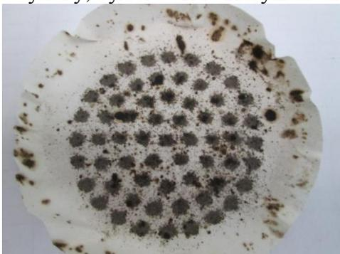
Рисунок 2. Фотография фильтровальной бумаги с отложениями после фильтрации отработанного раствора средства "Антиржавин".
